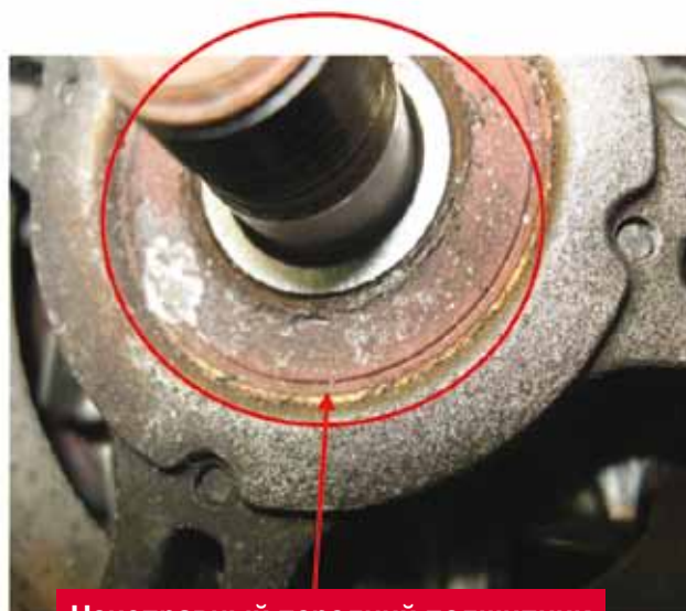
Неисправный передний подшипник
